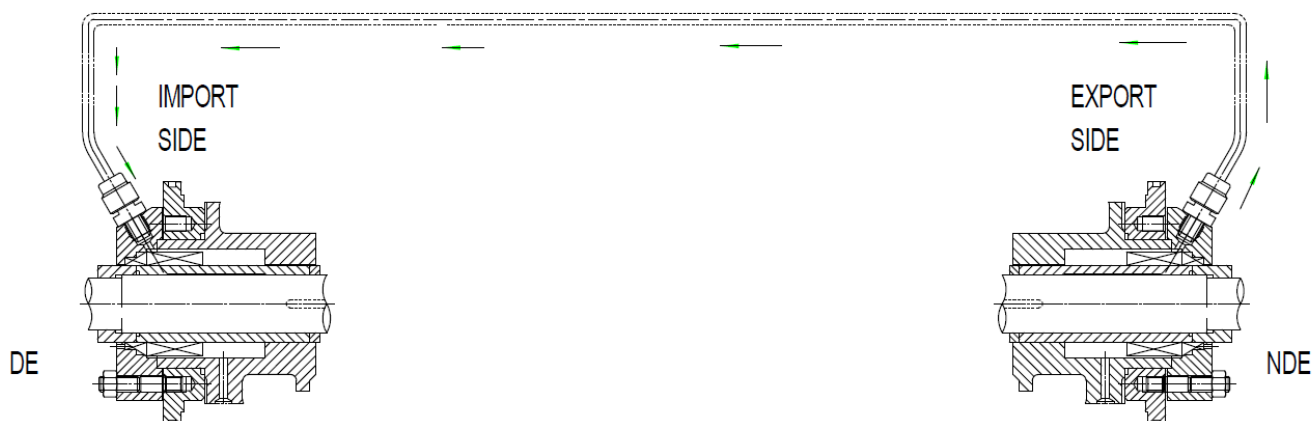
Схема промывки торцевых уплотнений (внутреннее подключение)
